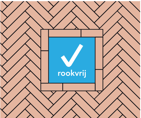
Inpassing waalformaat in trottoir ingezoomd (visgraatverband)
