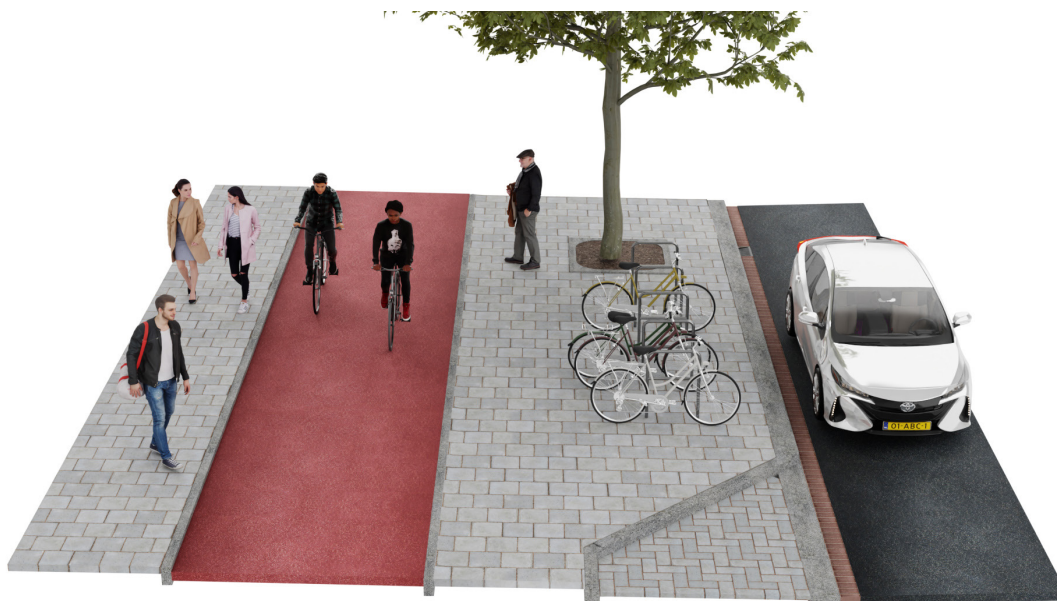
Afb. 1: nietjes tussen rijbaan en vrijliggend fietspad, haaks geplaatst
