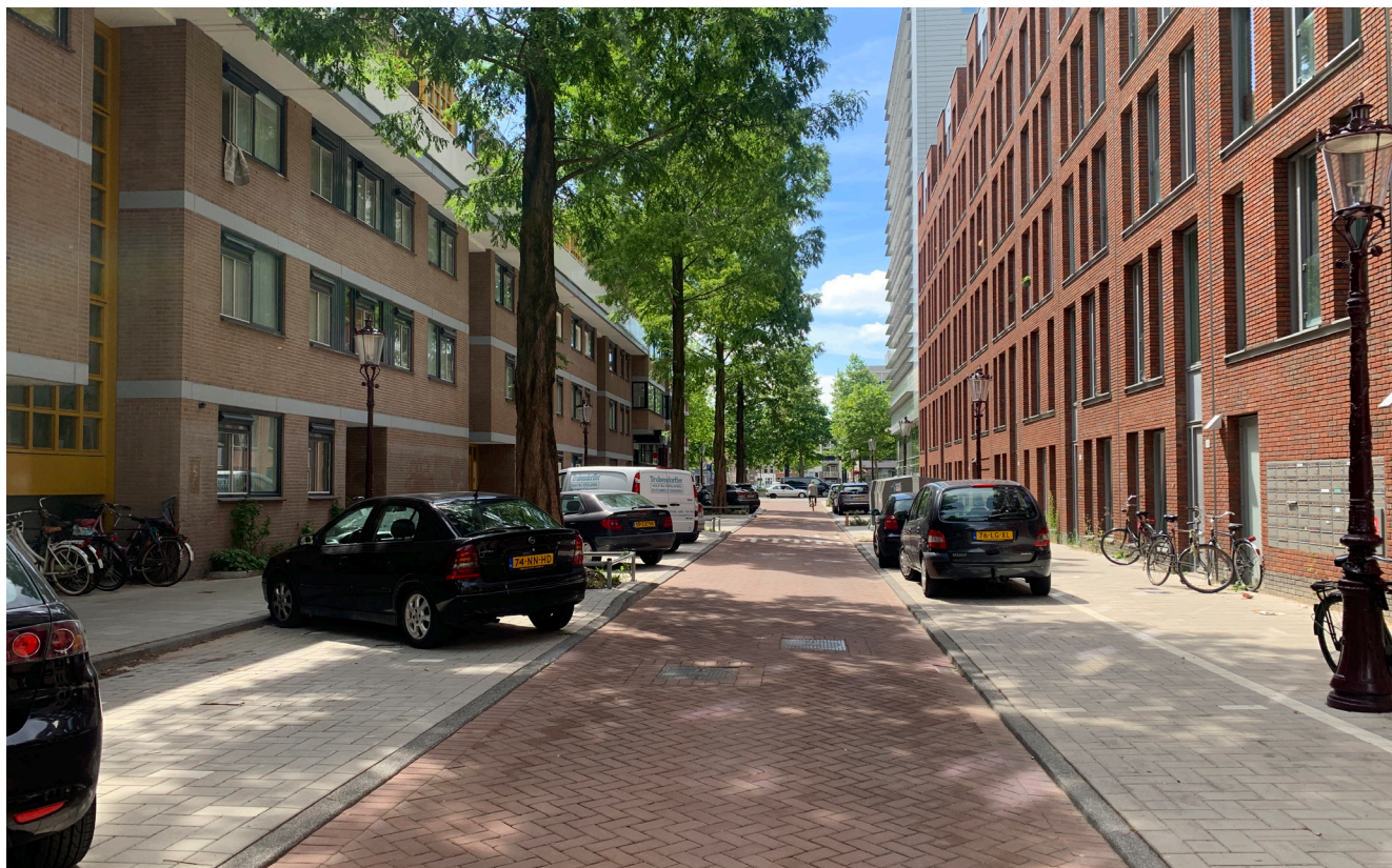
De Tilanusstraat. Een eenvoudige maar hoogwaardige inrichting voor een erftoegangsweg, conform de Puccinimethode, model Modern, links met 'tussenband', rechts zonder.
