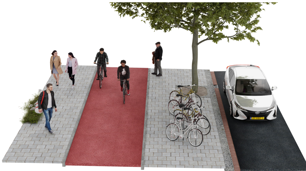
Afb. 2: nietjes tussen rijbaan en vrijliggend fietspad, onder een hoek geplaatst
